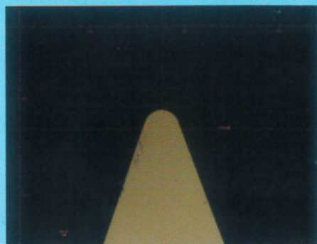
単結晶ダイヤモンドバイト R0.05mm 輪郭精度40nm/120deg
