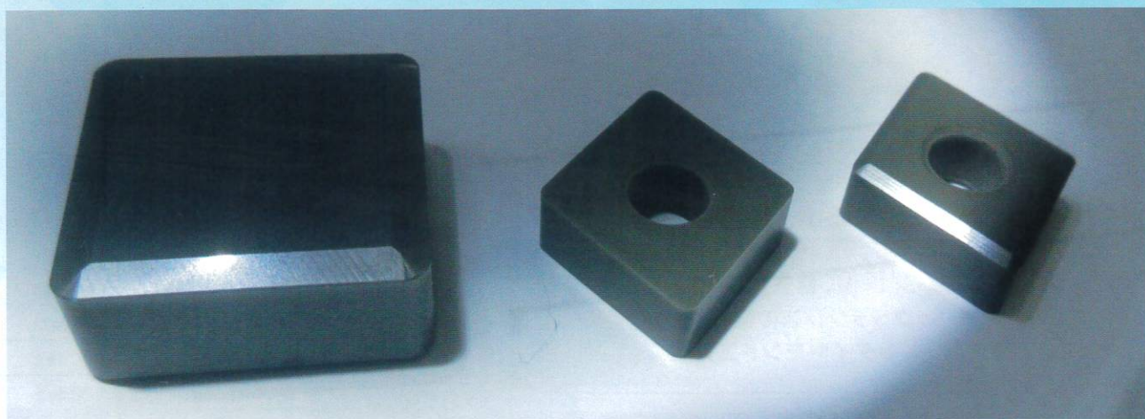
セラミックチップ 全外周研削、2段面取り研削
