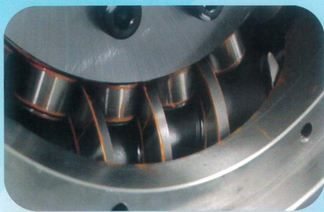
バックラッシュのないローラーカム構造
